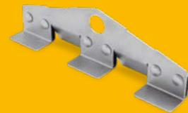
L'ancoraggio LVA 010 è costituito da una piastra in acciaio inox pressopiegata e delle graffette da serrare direttamente all'aggraffatura della lamiera. Nella parte superiore è presente un foro di diametro 33mm per l'ancoraggio del DPI. In caso di caduta l'elemento non si deforma. Il suo uso è previsto per ancoraggi su lamiera aggraffata.
